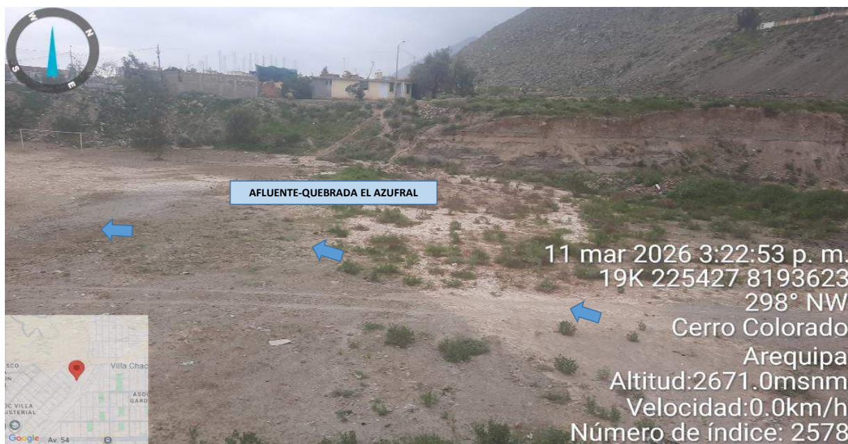
IMAGEN 02: EN ESTE TRAMO SE OBSERVA EN LA MARGEN DERECHA DEL AFLUENTE-QUEBRADA EL AZUFRAL, SU TALUD SE ENCUENTRA SOCAVADO Y DEBILITADO, Y EXISTEN VIVIENDAS CERCANAS A SU MARGEN; Y TAMBIEN SU CAUCE SE ENCUENTRA COLMATADO.
